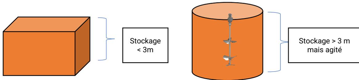
La hauteur des cuves de stockage des matières fermentescibles est fixé à 3 mètres maximum. Les cuves sur le site de déconditionnement font plus de trois mètres mais elles seront équipées d'agitateurs pour éviter les conditions d'anaérobie. Le stockage des biodéchets conditionnés respectera la hauteur maximale et sera donc inférieur à trois mètres.
